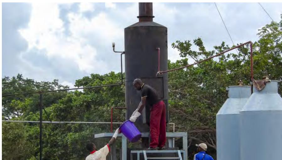
La COOPAKE a adopté un système de traitement thermique des noix de cajou basé sur la technologie H2CP (conçu par l'ONG Nitidae). Ce système permet de valoriser les déchets de coque d'anacarde comme combustibles en remplacement du bois de chauffe, sans émettre de fumée polluante.
